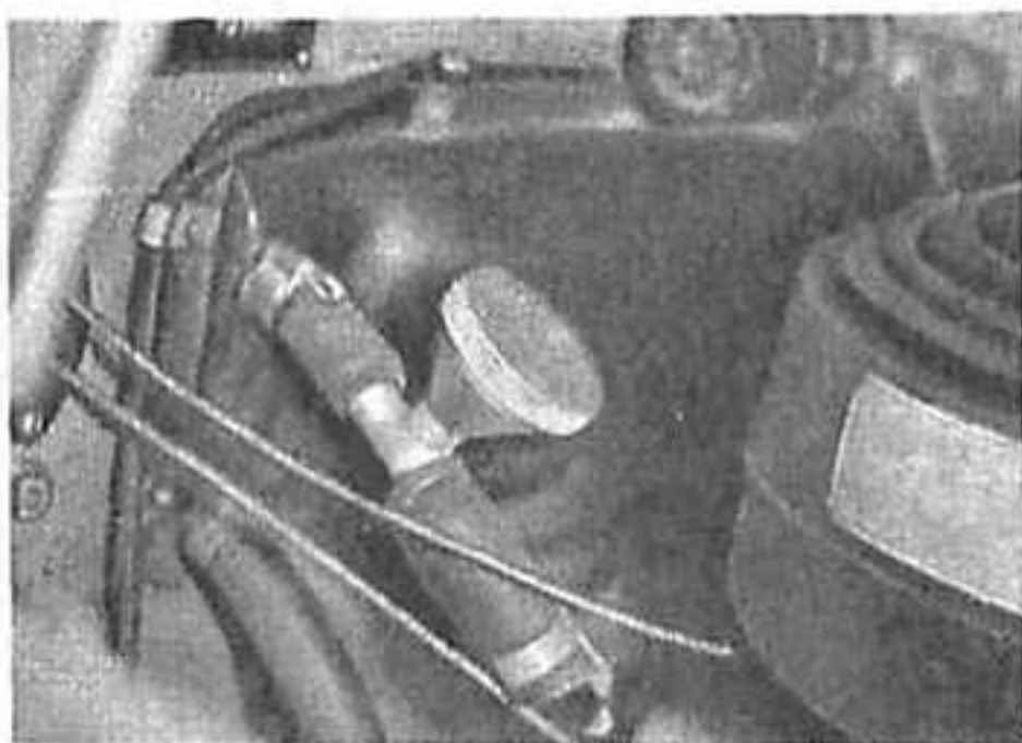
Установка воронки на «Москвиче»
